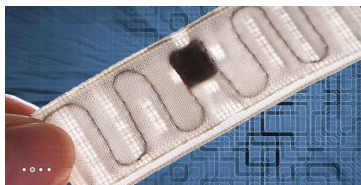
Étiquette RFID UHF intégrée dans les vêtements des pensionnaires
