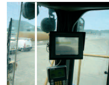
PC installé par B2A dans le chargeur
